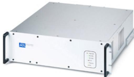
Passives Frontpanel mit LEDs
